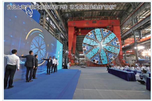
10月9日,首台具有完全自主知识产权的"上海制造"超大直径盾构"骐跃号",在上海国产盾构研发制造基地成 功调试下线。盾构整机总重约为3200吨,总长约为99米,最大推进速度为每分钟60毫米,将服务于上海轨道交通 市域线机场联络线工程,担任区间隧道掘进任务,将面临超长距离、大埋深、复杂地层等施工挑战
