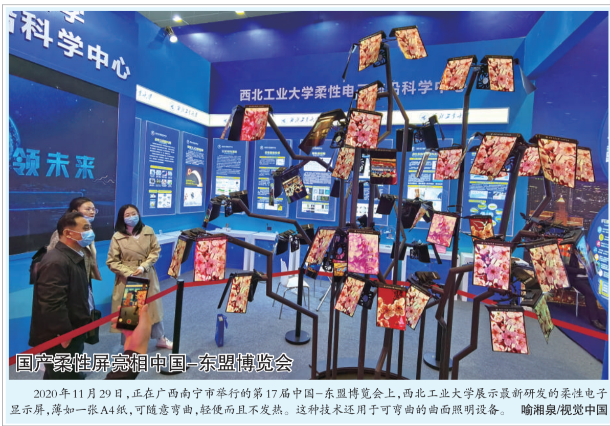
2020年11月29日，正在广西南宁市举行的第17届中国-东盟博览会上，西北工业大学展示最新研发的柔性电子显示屏，薄如一张A4纸，可随意弯曲，轻便而且不发热。这种技术还用于可弯曲的曲面照明设备。 喻湘泉/视觉中国
