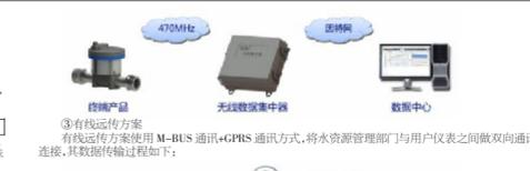
有线传输方案:通过有线方式将水表与数据集中器连接,再将数据集中器与用户仪表之间双向通讯连接,其数据传输过程如下:
