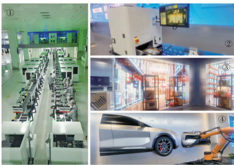
图①笔记本生产线自动化率超60% 图②智能质检场景 图③智能仓储场景 图④“智慧眼”AI视觉自动检查汽车零部件
