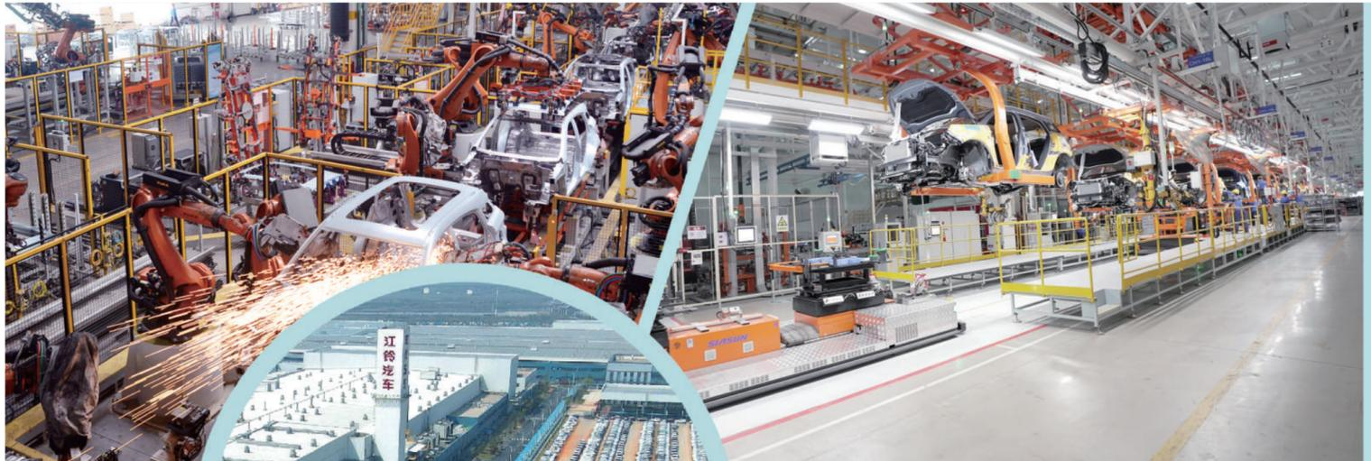
▲ 江铃汽车富山工厂焊装生产线
