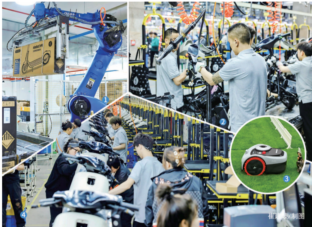
图①九号常州工厂的机械臂正在进行产品装载 图②电动两轮车生产线上的工人正在进行车架组装 图③九号公司智能割草机器人展示无边界规划式割草及避障能力 图④电动两轮车生产线上的工人正在进行最后的组装
