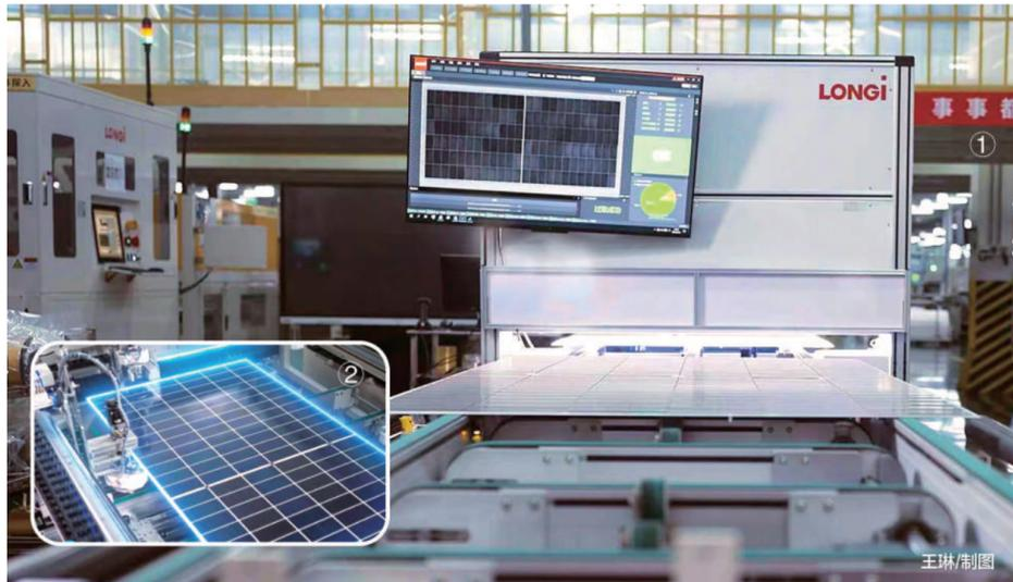
图①光伏组件智能化柔性生产工序
