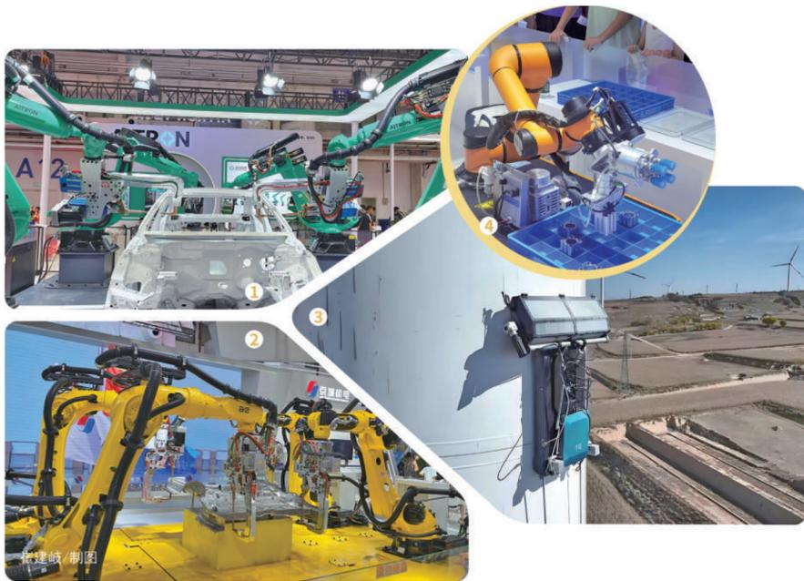
图1工业机器人进行新能源汽车四机联动点焊 图2工业机器人在协同作业 图3爬壁机器人在高空高危环境下作业 图4灵巧的机械臂在抓取零件
