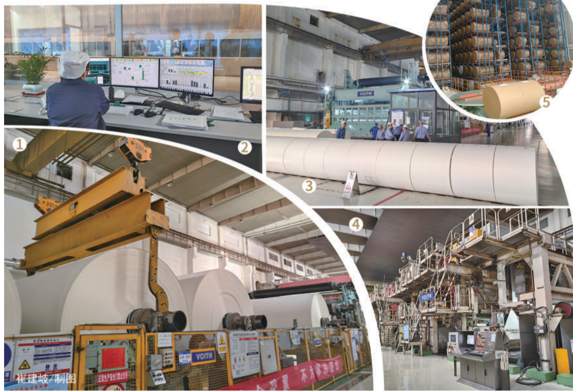
图①②③④博汇纸业投产于2003年,经过数智化改造升级的1号机产线,运行效率和产品质量大大提升 图⑤博汇纸业投产的8号机新产线,后端智能仓储实现了全流程的自动化、数智化
