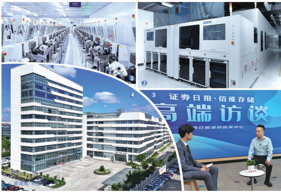
图1 佰维存储封装制造车间焊线区
