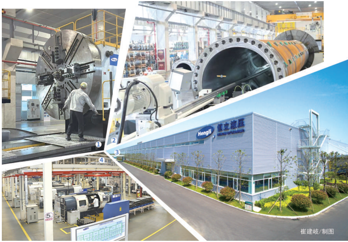
图①工人在操作车磨一体复合机 图②制造超大油缸的深孔镗床 图③恒立液压厂区 图④液压油缸加工车间
