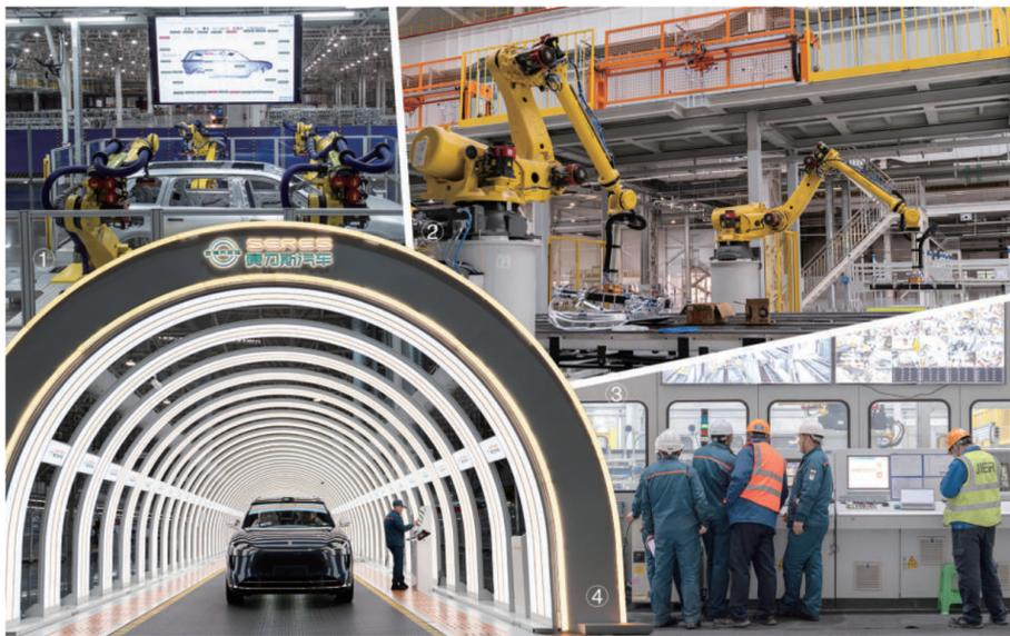
图①机器人正在给车身安装零部件，图片上侧是实时监控的数字屏 图②生产线上全自动化机器人正在作业 图③工作人员在数字系统前对汽车生产的各个环节做检测、核查 图④完成生产即将出厂的新新车 图片来源：公司供图
