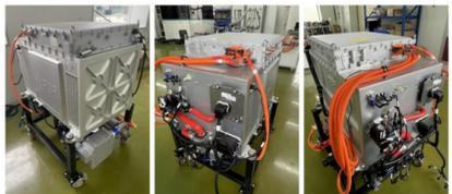
公司自主研发的新一代235kW功率的燃料电池系统已完成测试并正式投产...
