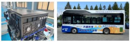
235kW 燃料电池发动机系统(HYFSCR-06)
