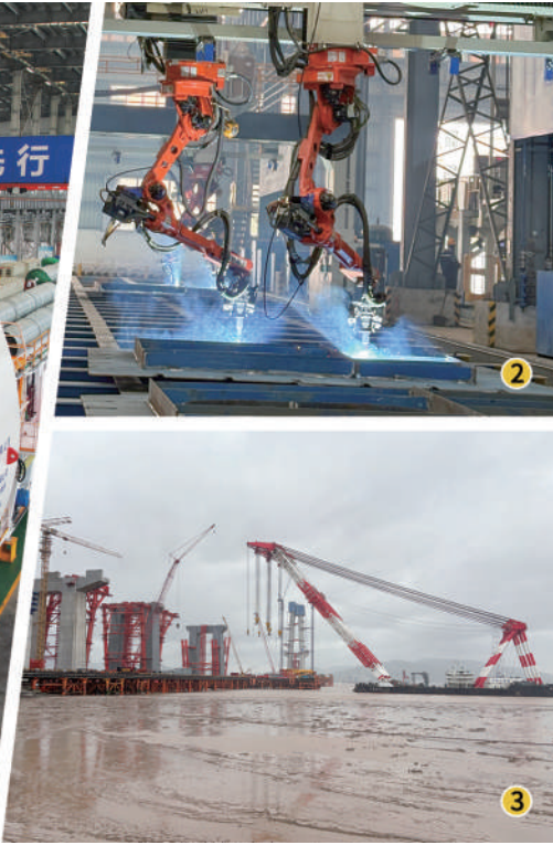
图②中铁宝桥舟山基地焊接机器人正在工作
