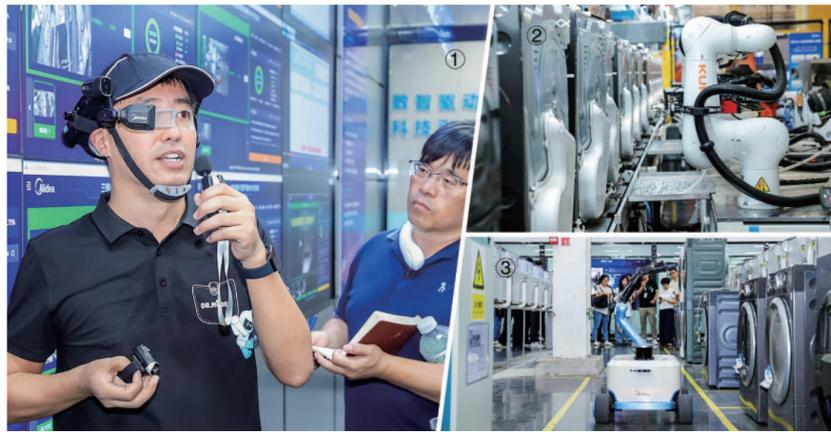
图①工作人员演示AI眼镜 图②库卡“nico”协作机器人 图③“玉兔”AI巡检机器人 公司供图
