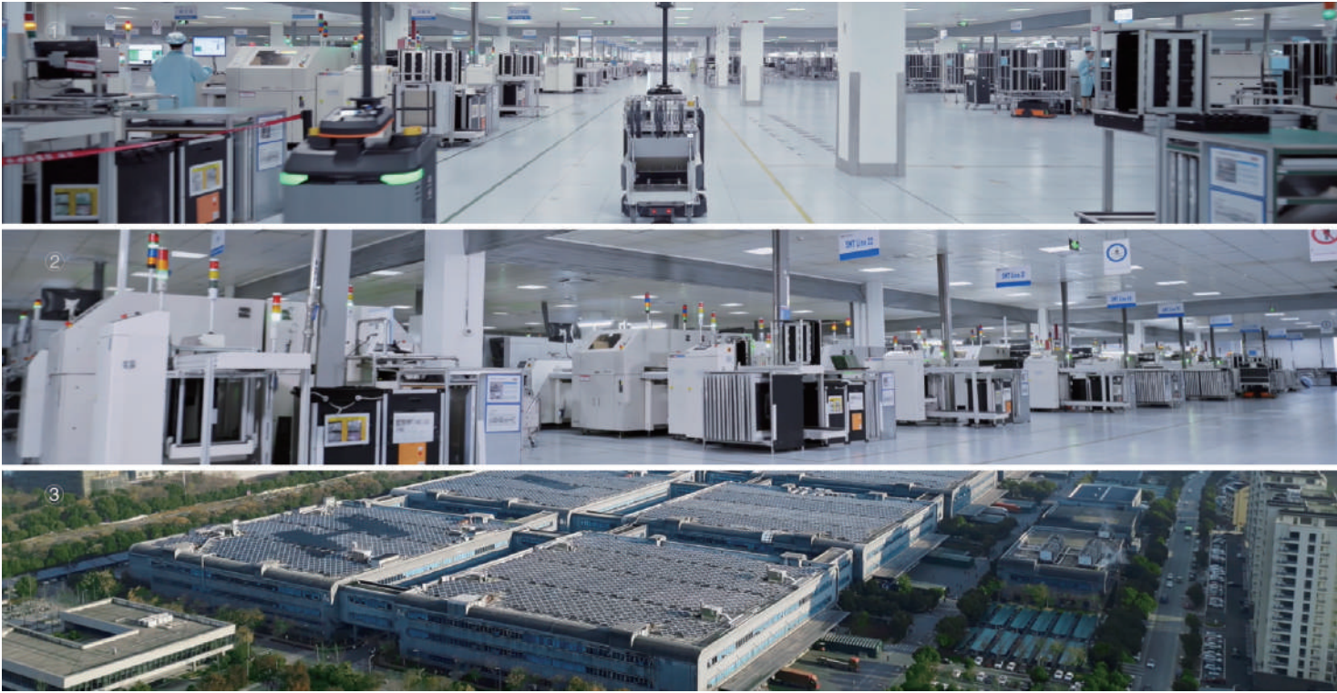
图①通过移动机器人实现物料精准配送到工位
