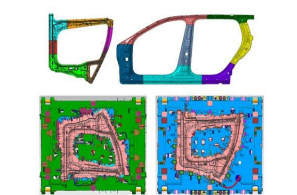
图:公司产品-单门环(左上)、双门环(右上)、热成型门环模具(左下、右下)
