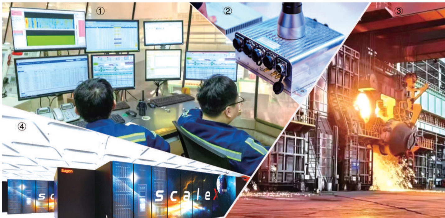
图①通过智能系统实现炼钢高效管控 图③大型转炉正在倾倒熔融的钢水
