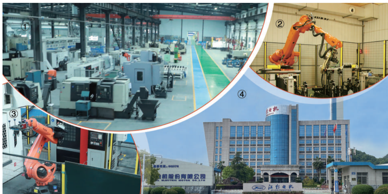
图①轴类加工自动化线 图②高压电机大中型自动包线机 图③铝机壳加工自动化线 图④江特电机宜春总部大楼
