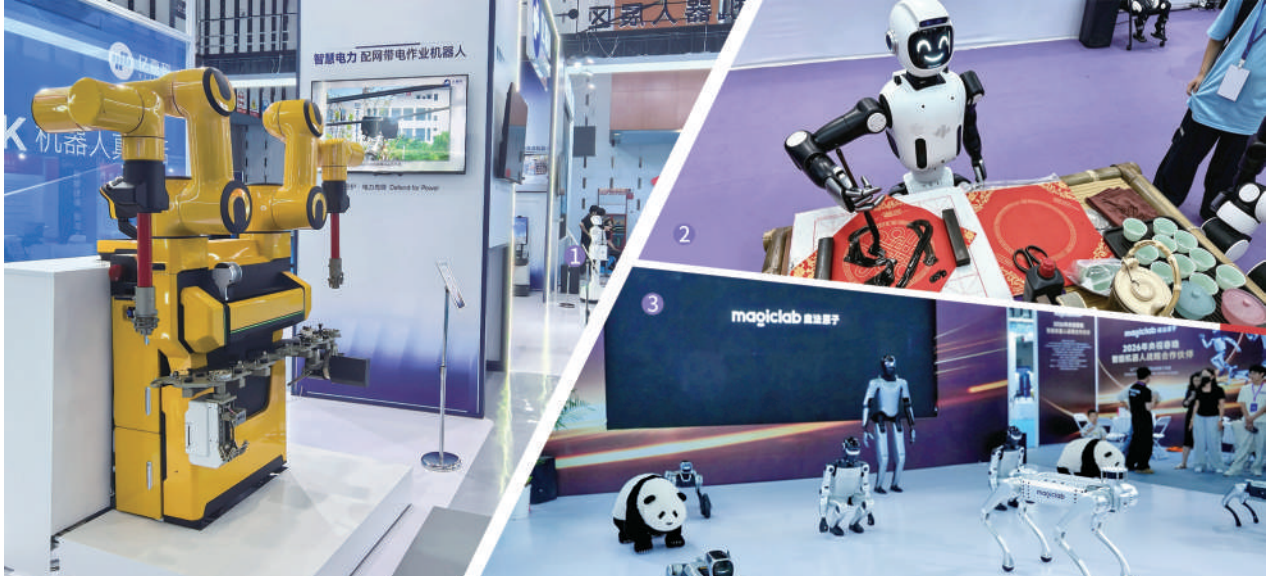
图①亿嘉和科技股份有限公司配网带电作业机器人
